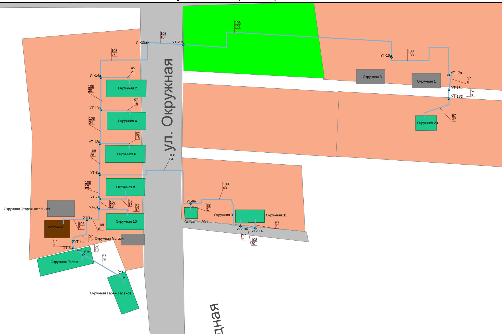
Рис. 6 Схема тепловых сетей котельной «Финский Комплекс» в режиме наладки
