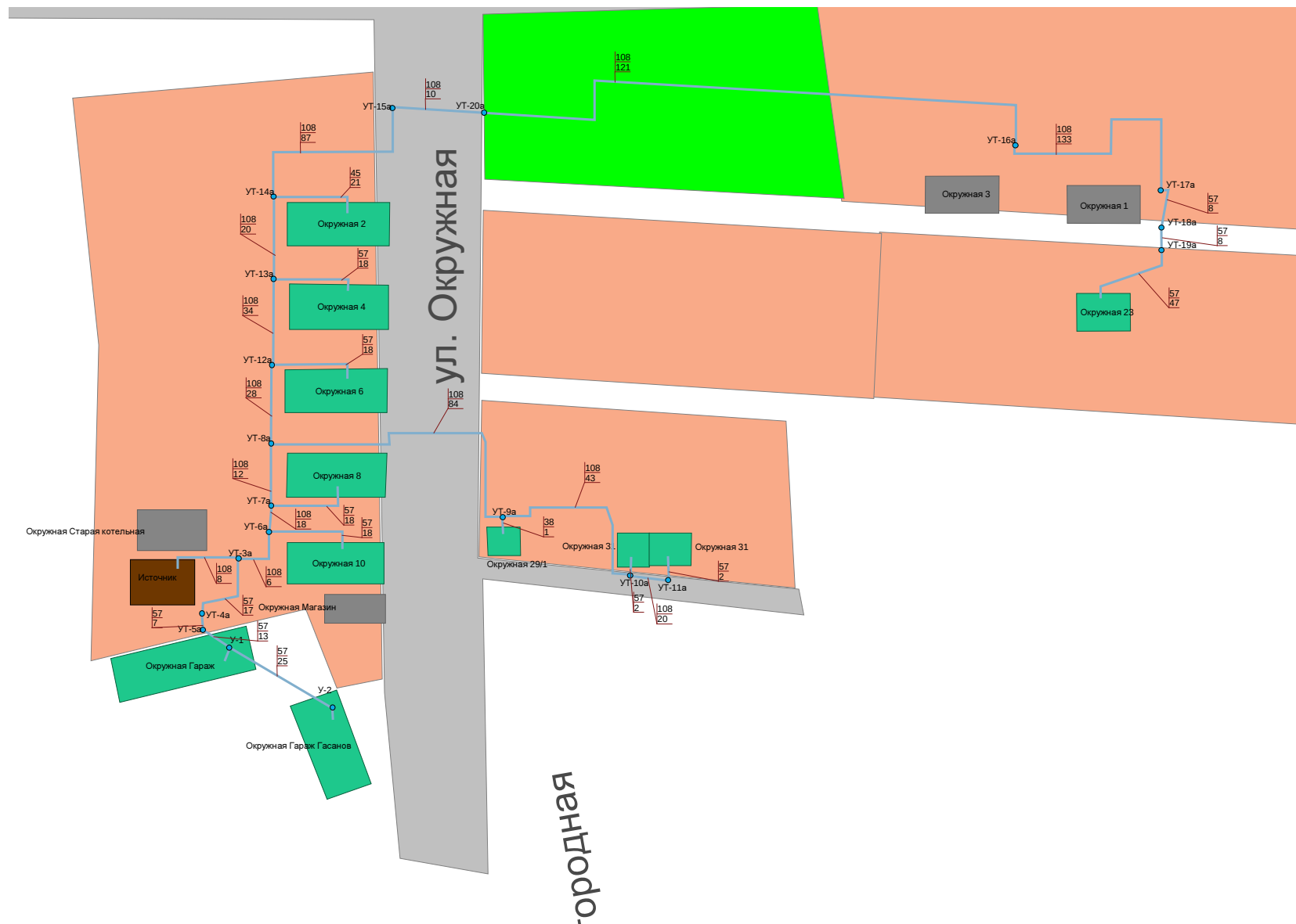
Рис 8. Котельная «Финский комплекс» - наладочный режим системы теплоснабжения (сети отопления)
