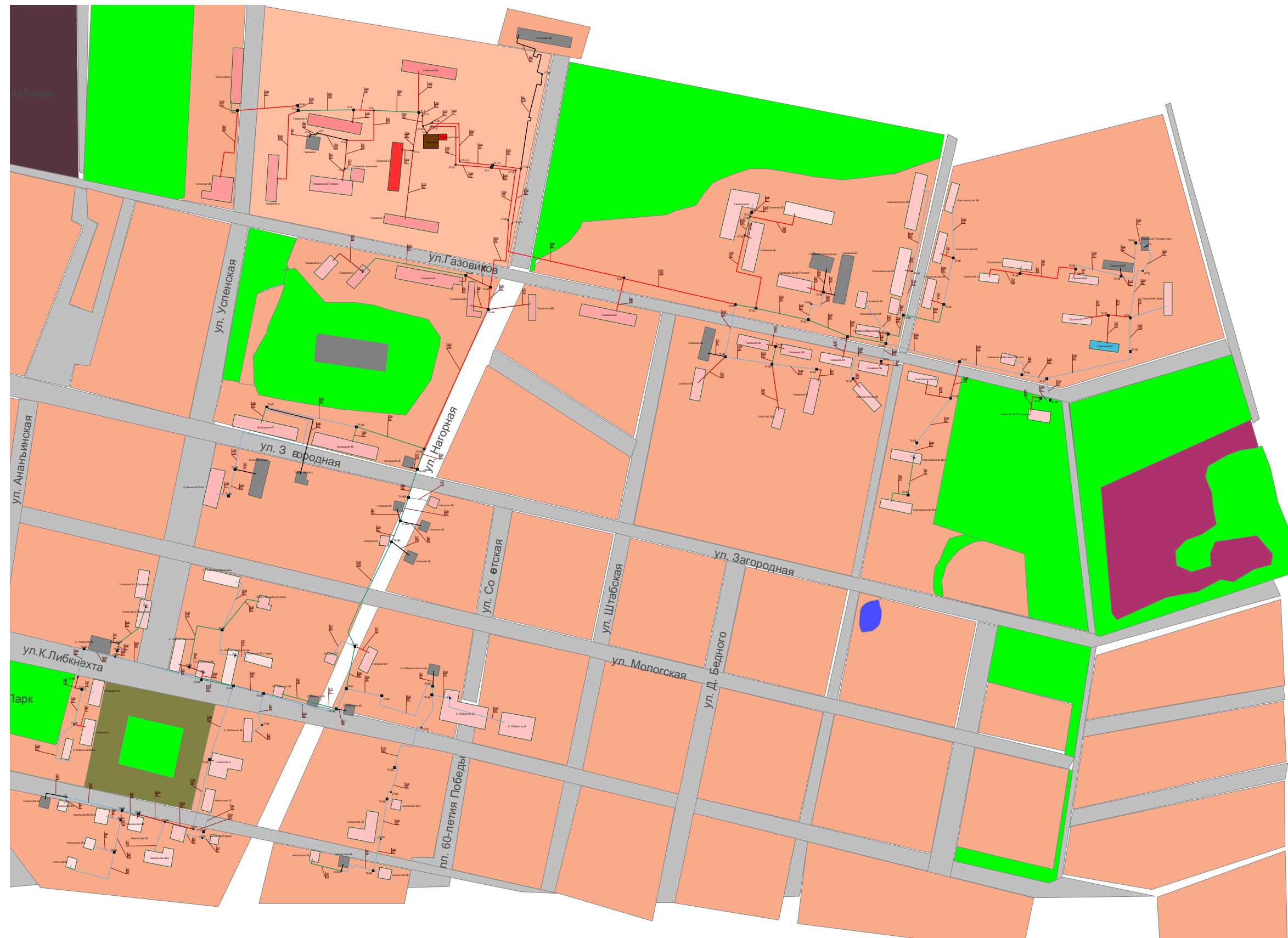
Рис.4 Котельная 26 квартала - существующее положение системы теплоснабжения
