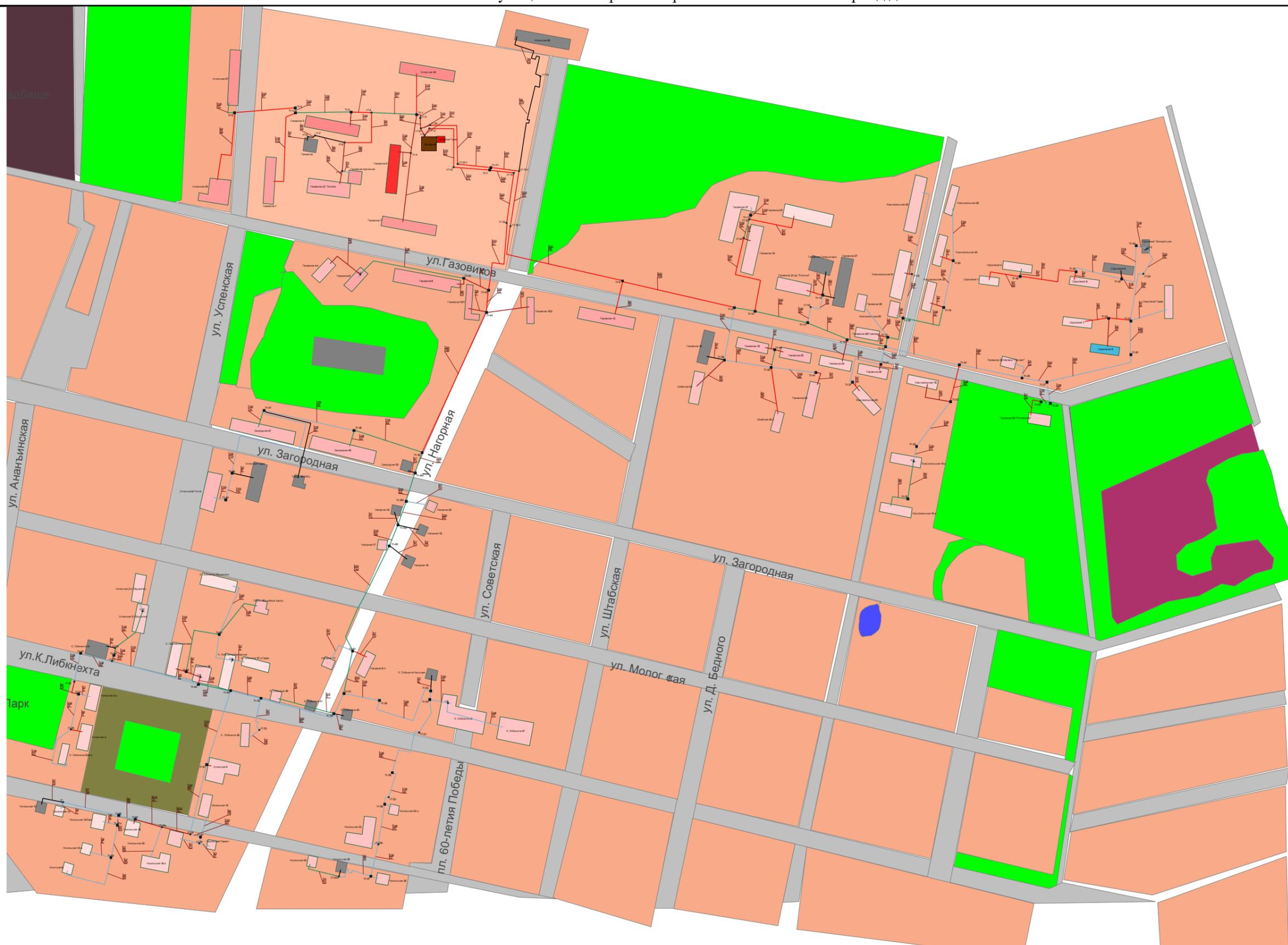
Рис.7 Котельная «26 квартал» - существующее положение системы теплоснабжения
